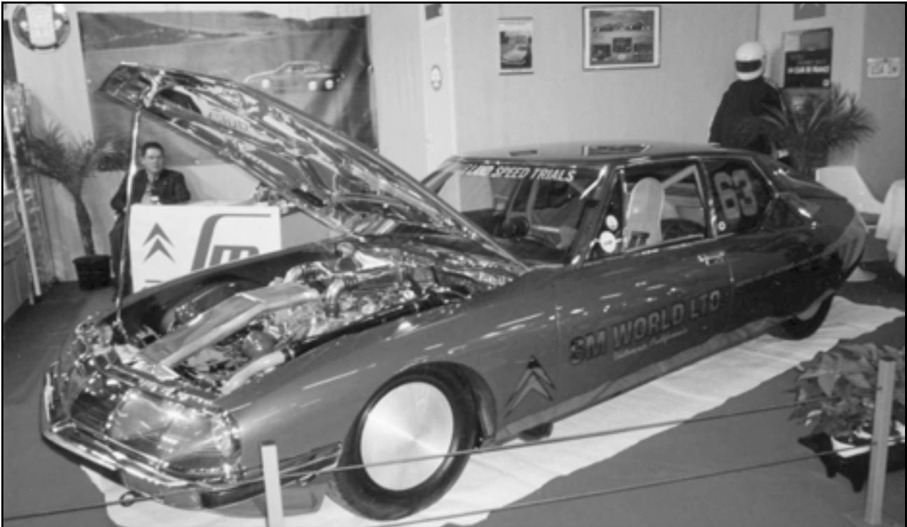
simo preparato), ma in realtà differivano poco dalla versione di produzione: il motore sviluppava solo 5 CV in più rispetto ai 170 di serie grazie ad uno scarico alleggerito, vi era una protezione sotto il motore ed il cambio, serbatoio maggiorato a 120 litri, ed in particolare vi fu il primo impiego delle famose "Ruote in Resina Rinforzata", realizzate appositamente da Michelin.
